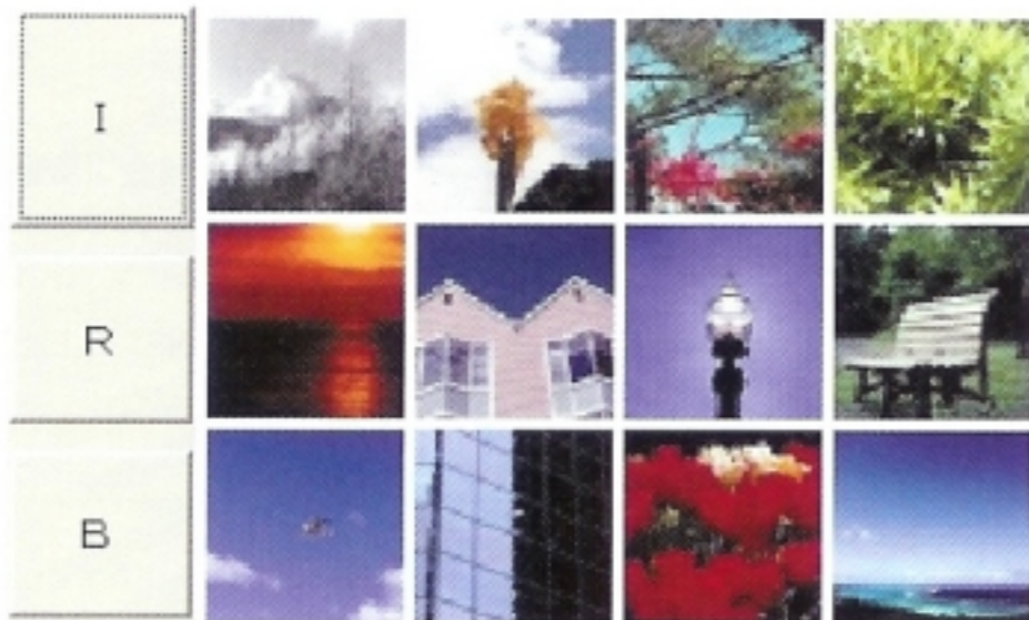
本人認証画面。記憶に基づいた画像アイコンを選ぶことによって、忘れにくい認証システムを実現している。
